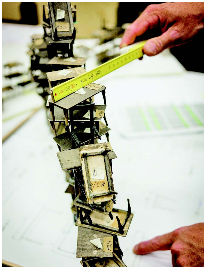
Kartonmodell im Maßstab 1:25: Auf der Bühne wird die Konstruktion aus 120 Tischen sechs Meter hoch sein
